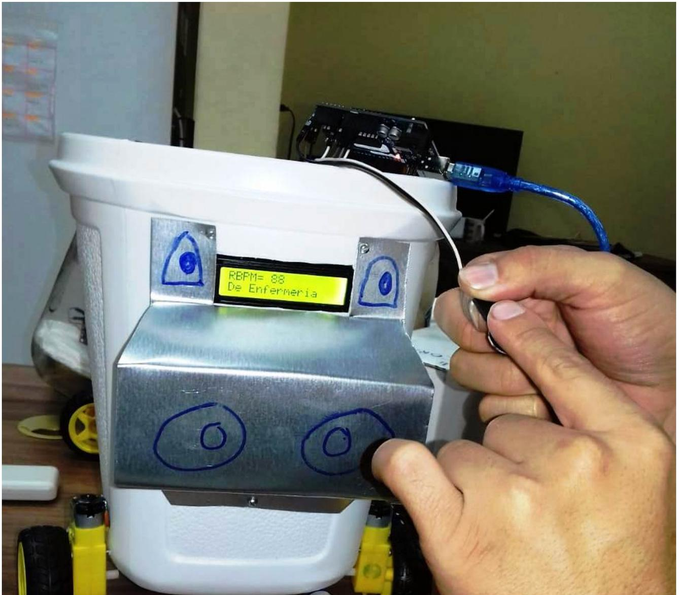
El proyecto consiste creación (ensamblaje) de un robot que tendrá la capacidad para medir la temperatura corporal, la frecuencia cardíaca y la glucosa del paciente. Este prototipo será táctil y tendrá voz para comunicar los resultados.
